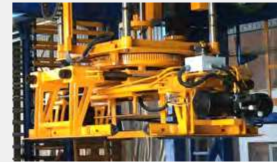
Palettisation 4 côtés servocommande
